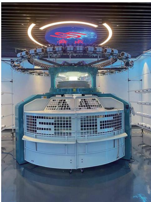
1. 高机号数字圆纬机成圈编织及高效调整技术，创新设计了数字圆纬机智能选色喂纱机构，发明了可调式分体针盘底座、高精度连体芯轴套管等关键机构，构建了起针角及收针角与织针运动控制三角曲线数学模型，实现了 50E 以上机号的高质量成圈编织，首创了针筒间隙数字化调整装置和上下三角对位调整装置，摆脱了依赖资深调机师傅凭借经验调机的传统模式；
