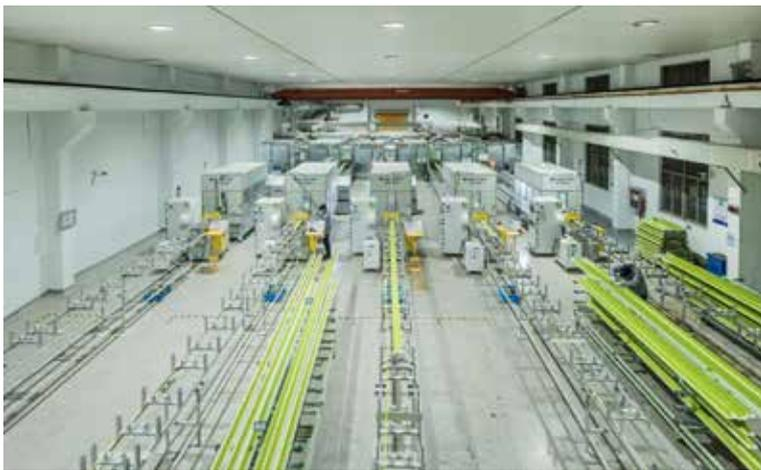
项目攻克了碳纤维多层织物复杂异型结构件快速拉挤成型技术及成套装备的核心技术，开发了具有国际同类先进水平的复杂异型结构件快速拉挤成套装备，装备成本及产品生产成本远低于国际同类水平，实现了大规模工业化高效生产。
